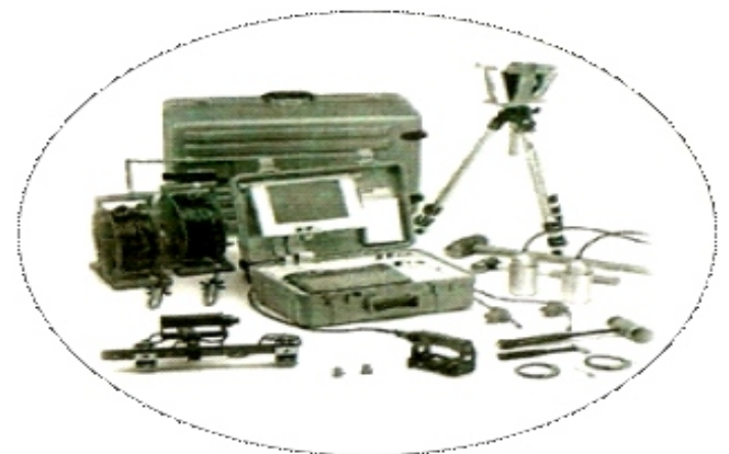
Thiết bị siêu âm kiểm tra chất lượng cọc CLS – 2
